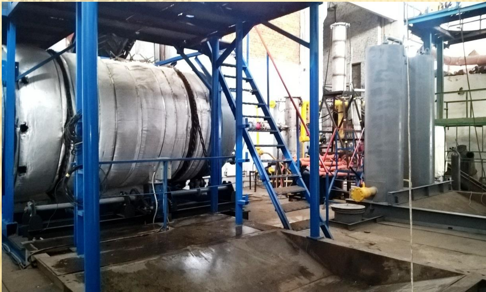
Пиролизный модуль ЭКУОТ в составе пиролизного агрегата, блока конденсации парогазовой смеси и АСУ
